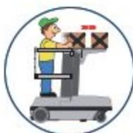
Diese Ladefläche ist bei maximaler Hubhöhe gleich so hoch wie die Säule. Dies ist sehr nützlich, weil sogar die schwersten Pakete mit der Säule als Grundlage geschoben werden können.
